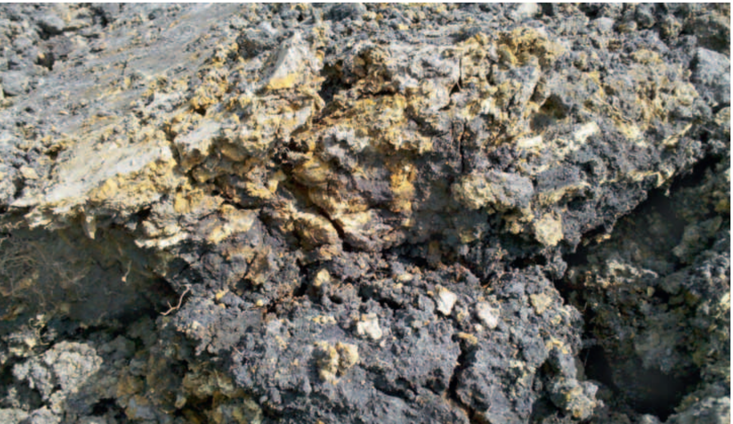
Abbildung 6: An strohgelben Jarositausfällungen erkennbarer aktuell sulfatsaurer Bodenaushub
