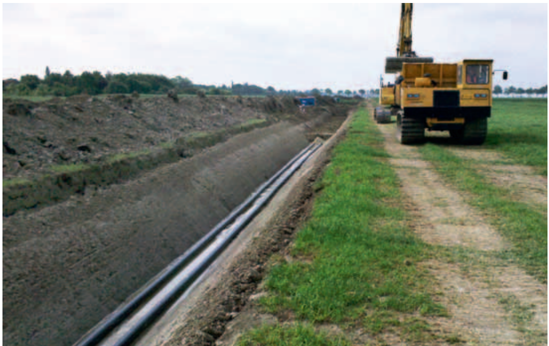
Abbildung 2: Kettenfahrzeuge weisen i.d.R. sehr geringe Kontaktflächendrücke auf und eignen sich daher auf den meisten Böden auch für schwere Transporte
